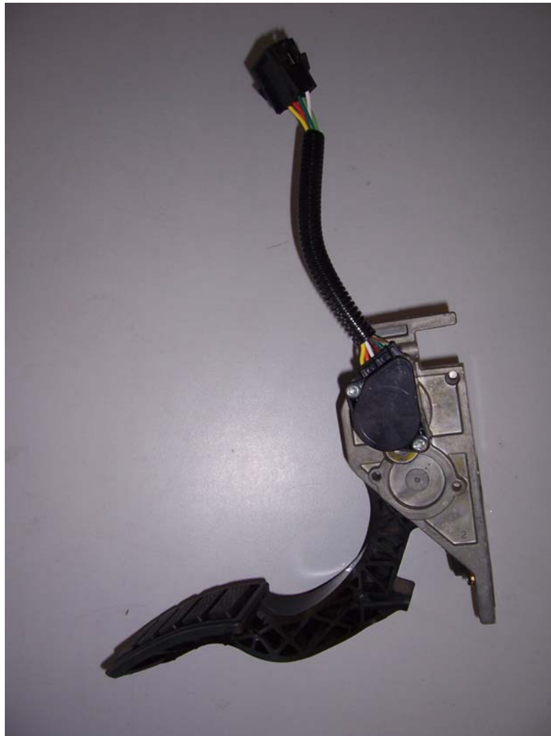
Abbildung 13 Elektronisches Gaspedal mit Potentiometersensor (aus Wikipedia)
