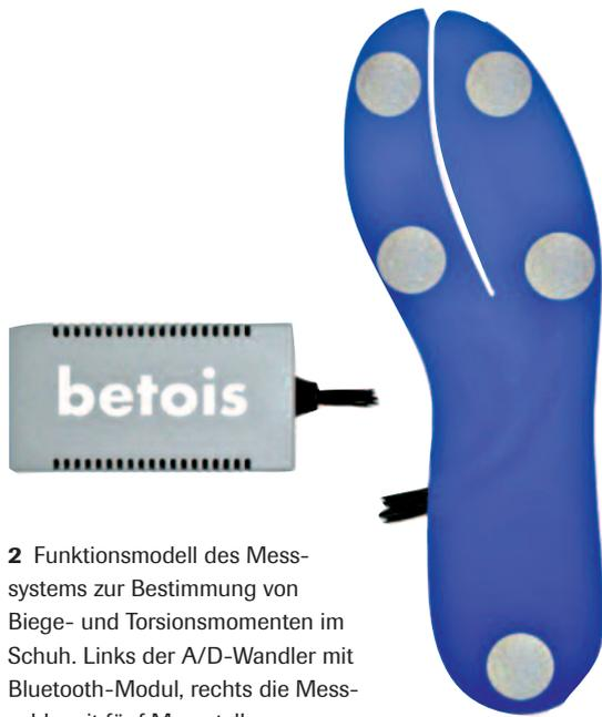
2 Funktionsmodell des Messsystems zur Bestimmung von Biege- und Torsionsmomenten im Schuh. Links der A/D-Wandler mit Bluetooth-Modul, rechts die Messsohle mit fünf Messstellen.
