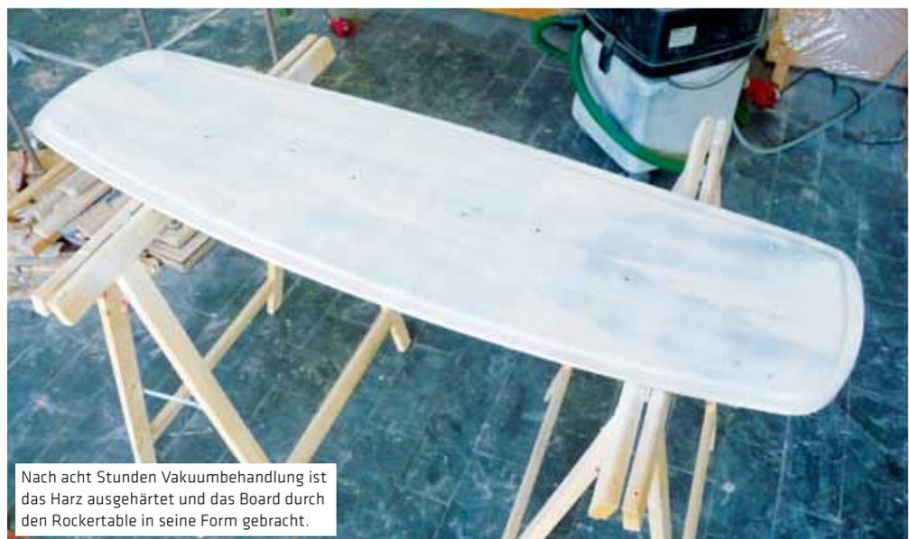
Nach acht Stunden Vakuumbehandlung ist das Harz ausgehärtet und das Board durch den Rockertable in seine Form gebracht.
