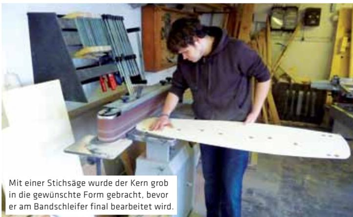
Mit einer Stichsäge wurde der Kern grob in die gewünschte Form gebracht, bevor er am Bandschleifer final bearbeitet wird.
