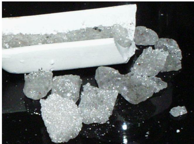
Abbildung 10: Kompaktierte Glaspulver nach Behandlung bei 550°C in überhitztem Wasserdampf
