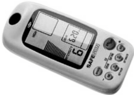
Abbildung 5: Safesun, ein kommerziell verfügbarer UV-Sensor
