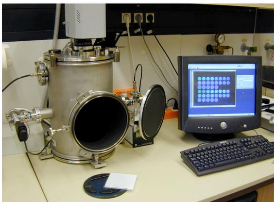
**Abbildung 4:** Messapparatur zum High-Throughput-Screening von Mehrphotonen-Leuchtstoffen
