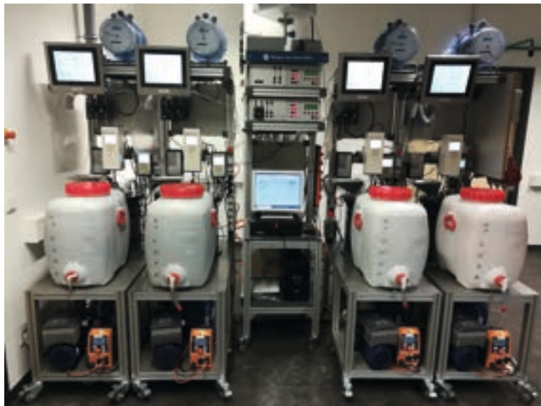
Abbi: Versuchsaufbau der Rührkesselreaktoren
