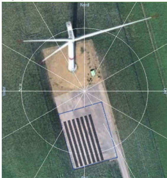
Abbi: Kranstellfläche der Beispiel-WEA mit PV-Modulen
