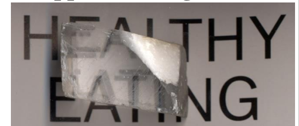
Calcit-Kristall (oben) Demonstration der Doppelbrechung (unten)
