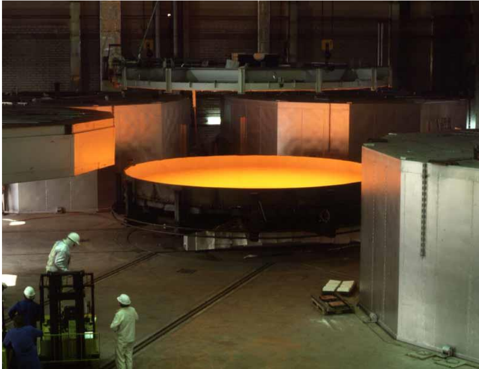
Teleskopspiegelfabrikation bei Schott in Mainz
